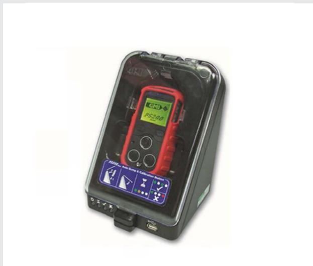
Il rilevatore **PS200** rileva fino a 4 gas contemporaneamente: LEL (combustibili), O<sub>2</sub>, CO, H<sub>2</sub>S. Tutte le misure sono visualizzate a display ed è possibile, inoltre, eseguire in ogni momento un bump test. Lo strumento viene fornito con caricabatterie/USB, manuale di istruzioni, certificato di taratura e, la versione con pompa integrata, con 3 mt. di tubo per prelievi a distanza.
