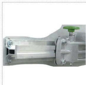
Cuscinetti nel carrello di scorrimento e volantini
