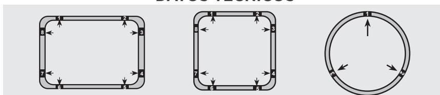
Para las tapas de pozo cuadradas o rectangulares, es necesario fijar 8 topes de pozo cerca de las esquinas del marco. Para las tapas de pozo redondas, se necesitan 3 topes de pozo fijados en posición triangular para lograr el mejor resultado triangular para obtener el mejor resultado.
