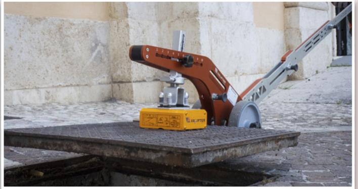
El imán Rhino Slim Dumped no requiere alimentación eléctrica, permite **realizar intervenciones rápidamente** sin renunciar a la seguridad, libera al operario de la búsqueda, limpieza y uso de los puntos de enganche colocados en las tapas de las alcantarillas.
