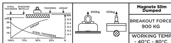
El imán Rhino Slim Dumped integra el acoplamiento rápido unificado, haciendo que el imán sea compatible con cualquier sistema de elevación **VALIFTER**.
